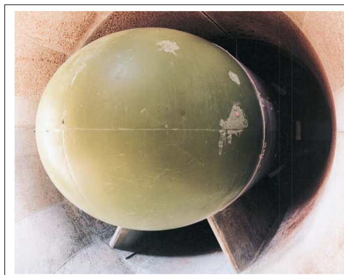
Der Wavegen-Generator mit Wellsturbine: Symmetrisch geformte Schaufeln erhalten einen Drehimpuls, wenn sie im rechten Winkel angeströmt werden. Kehrt sich die Luftströmung um, bleibt die Drehrichtung gleich.
